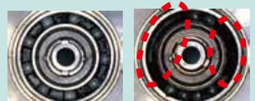
ベアリングの破損→軸ブレ・発熱
