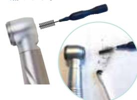
3 お手持ちのオイルスプレーに付属の注油ノズルを付けて汚れが出なくなるまで、チャック内の汚れを押し流してください。
